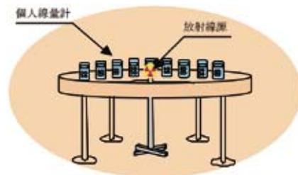
図2 個人線量計の実用校正の例
