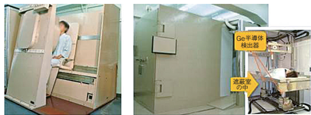
写真1 (左) 簡易型全身カウンタ (右) 精密型全身カウンタ
