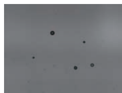
高速中性子による反跳陽子の飛跡
