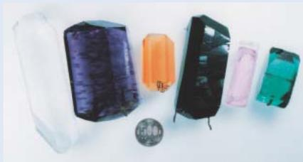
合成水晶の原石。左から「ロック・クリスタル」「アメシスト」「シトリン」「スモーキー・クォーツ」「ローズ・クォーツ」「グリーン・クォーツ」で、結晶の色は照射された放射線により発色したものである。
