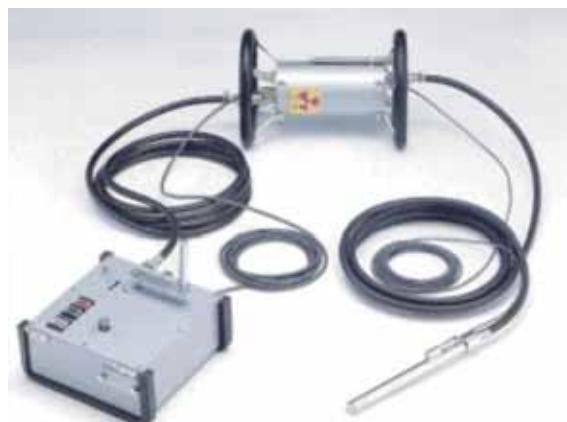
ポニー工業(株)製  $^{192}\text{Ir}$  ガンマ線透過試験装置 PI-104H
