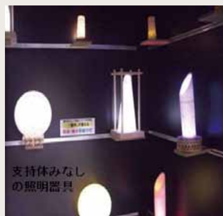
図2 ゲル改質和紙の吹き付けコーティングにより製造したランプシェード
