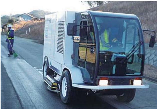
高压吸水洗浄車による道路の除染状況
