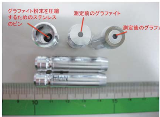
AMSの分析対象となるグラフィット・ターゲット (本体:アルミニウム製、長さ:44mm、直径:10mm) (グラフィット:直径2mm、厚さ:数ミリ)
