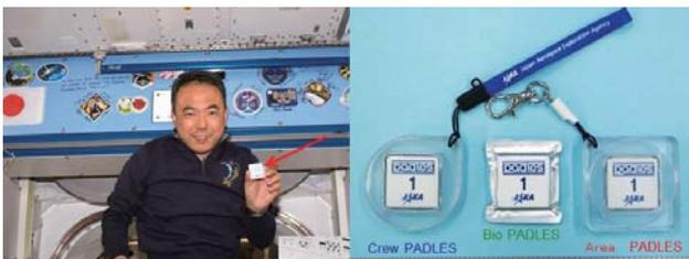
図1 「きぼう」船内でPADLES線量計を持つ古川聡宇宙飛行士(左)と様々なケースにはいったPADLES線量計
