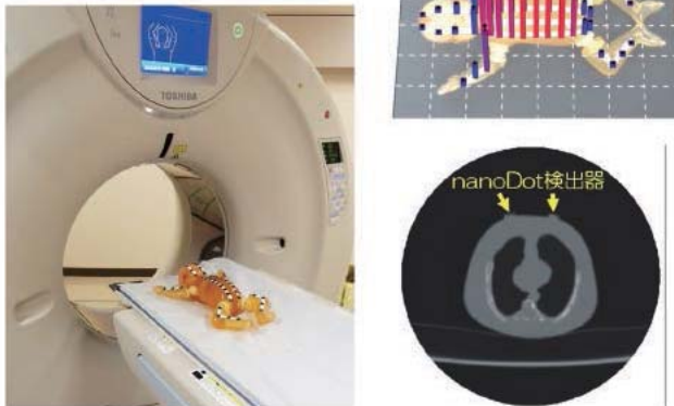
図1 新生児ファントムを用いたCT検査における被ばく線量測定例
