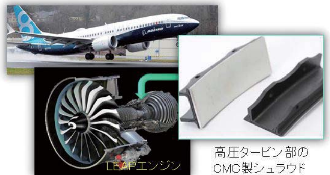
図3 CMC製シュラウドとそれを採用したジェットエンジン
