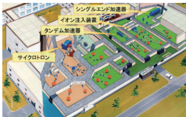
図1 TIARAの全体像。イオンビーム輸送ラインの途中または末端の赤い丸は照射装置
