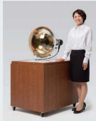
図2 カミオカンデに使われている光電子増倍管
